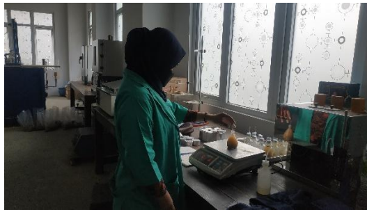
Gambar 3. 9 Penggunaan Neraca Digital Pada Pengujian Berat Jenis Tanah
