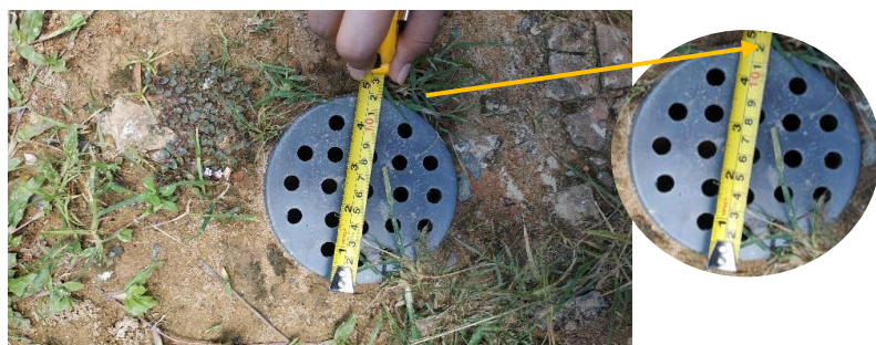
Gambar 3. 4 Pengukuran Diameter LRB
