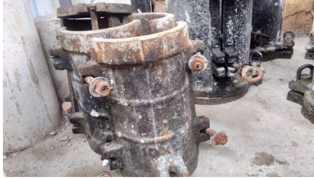
Gambar 3. 17 Cetakan Silinder ukuran 10 cm x 20 cm
