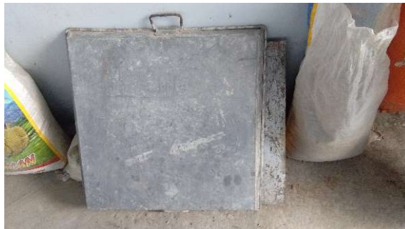
Gambar 3. 16 Pan Besar untuk adukan beton
