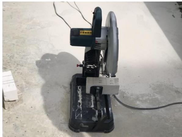
**Gambar 3. 6** Alat Pemotong ukuran Kubus
