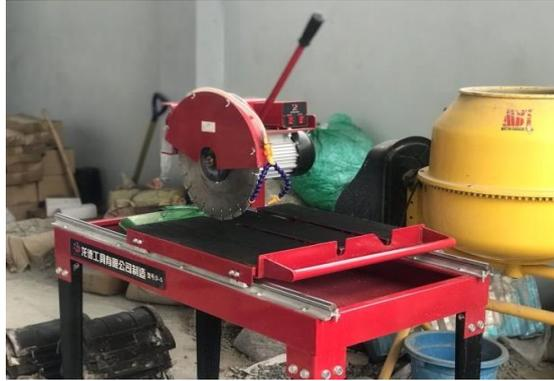
**Gambar 3. 7** Alat Pemotong bata ringan untuk ukuran 60 x 10
