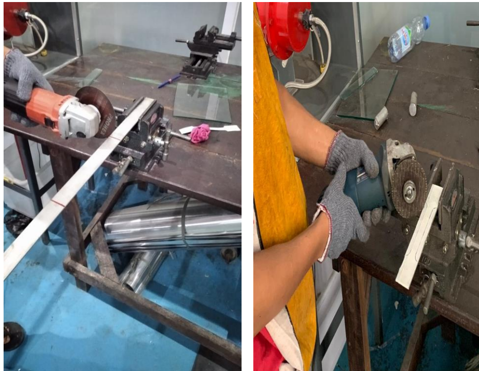
Gambar 3.1 Pemotongan dan Pembuatan Spesimen
