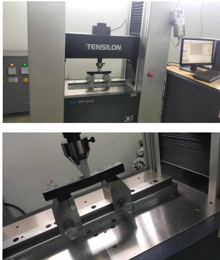
**Gambar 3. 27** Pengujian *Bending* Menggunakan *Universal Testing Machine*
