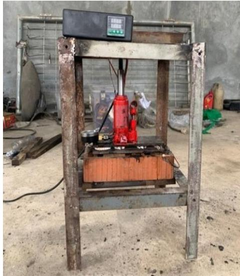
**Gambar 3. 7** Mesin Pengepresan Cetak Tekan Panas
