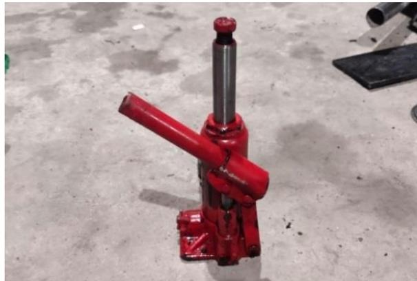
**Gambar 3. 8** Dongkrak Hidrolik
