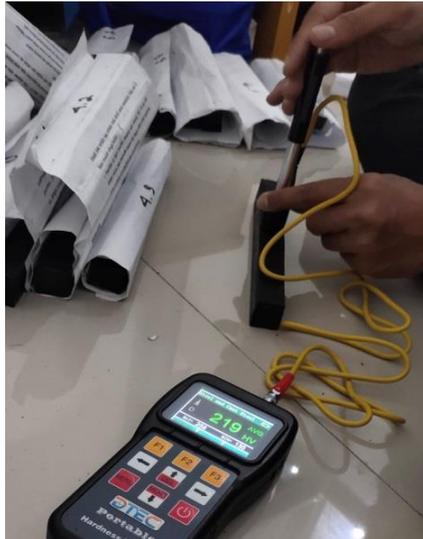
**Gambar 3. 26** Pengujian Kekerasan pada Komposit
