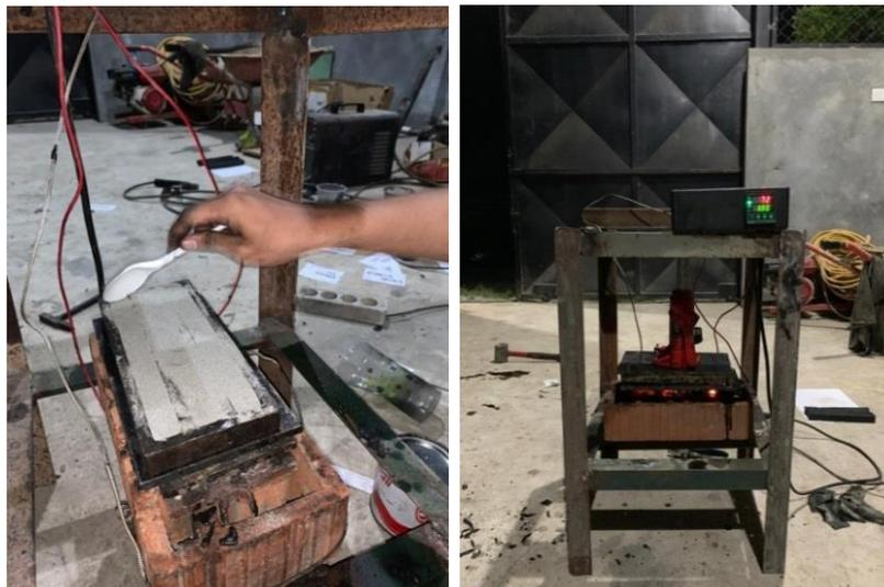
**Gambar 3. 22** Pencetakan Spesimen dan Penekanan Panas
