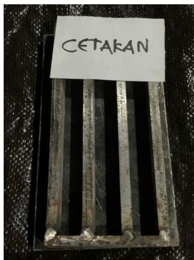
**Gambar 3. 9** Alat Pencetakan Spesimen
