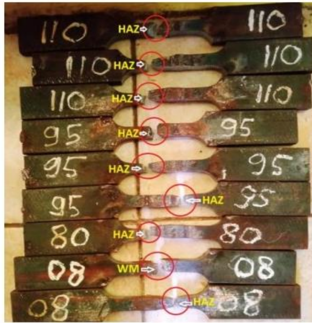
Gambar 2.6 Hasil patahan uji tarik (Sumber : Sulaiman dkk., 2022)
