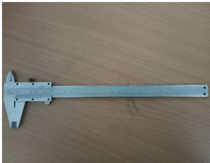
Gambar 3.4 Jangka Sorong Sumber: Dokumentasi Pribadi
