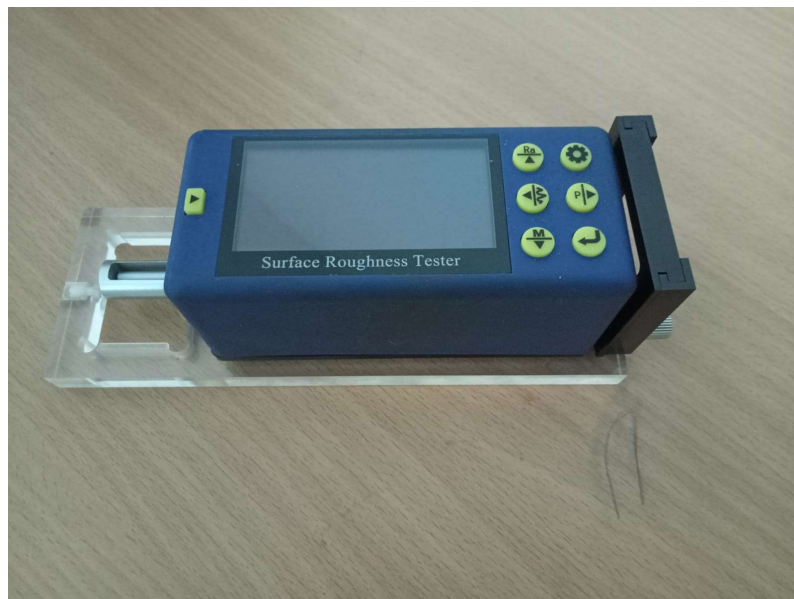
Gambar 3.10 Surface Rougnes Tester Sumber: Dokumentasi Pribadi
