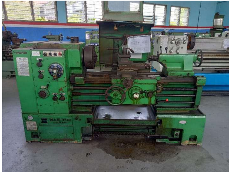
Gambar 3.3 Mesin Bubut Konvensional Sumber: Dokumentasi Pribadi
