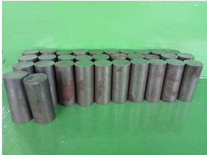
Gambar 3.8 Poros Baja ST37 Sumber: Dokumentasi Pribadi
