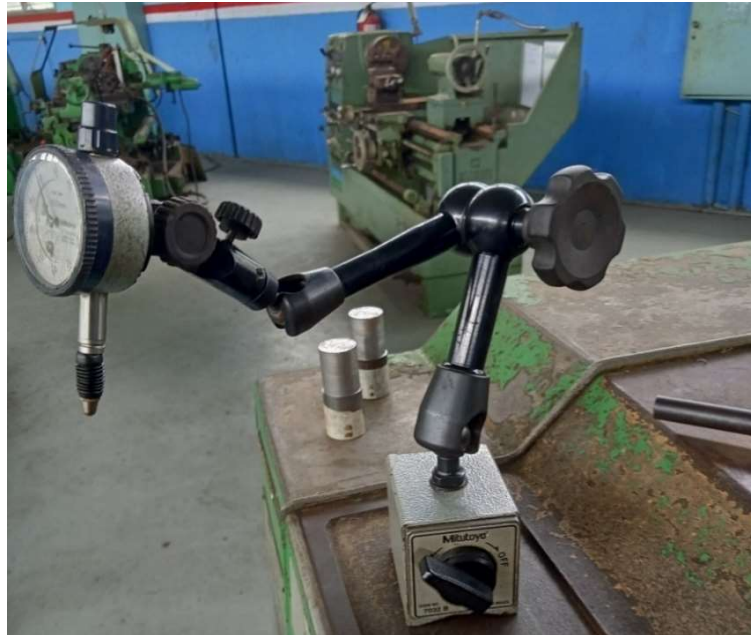
Gambar 3.5 Dial Indikator Sumber: Dokumentasi Pribadi
