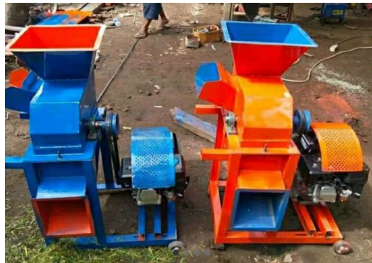
Gambar 2.1 Mesin Pencacah Plastik Sumber: (Mochamad Syamsiro, 2016)
