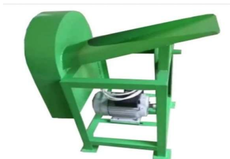
Gambar 2.3 Mesin Pencacah Organik Sumber: (Noviyanti Nugraha, 2019)
