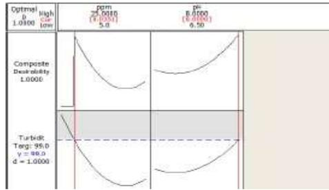
Nilai *composite desirability* dari gambar diatas yaitu 1.0000 artinya tercapai sudah nilai target yang diinginkan. Penurunan *total suspended solid* dengan target 99% didapatkan dengan dosis koagulan 15 ppm dan pH 7,9. Pada hal ini, diketahui pH tidak mempengaruhi kinerja koagulan karena rentang pH yang digunakan dalam kisaran kecil menyesuaikan dengan kondisi lapangan.maka hasil pulungan yang didapat juga akan meningkat.
