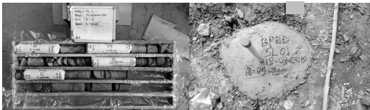
Gambar 7. (a) Core Hasil Pemboran Geoteknik; (b) Instalasi Piezometer
