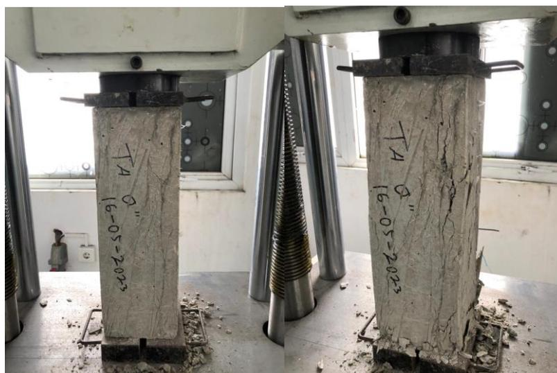
**Gambar 3.1** Pengujian Kuat Tekan Beton dan Pola Kerusakan Pada Beton
