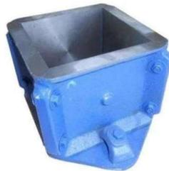
Gambar 2 Cetakan Benda Uji Kubus
