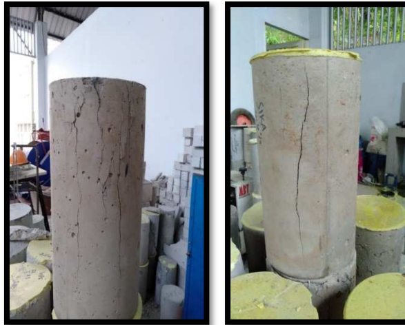
Gambar 4. 2 Jenis Keretakan Dengan Jenis Kehancuran Sumbu Tegak (Kolumnar)
