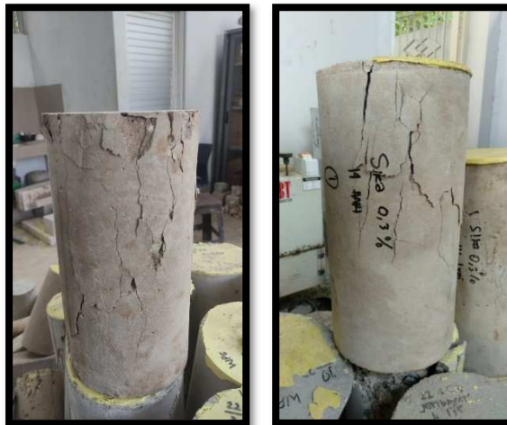
Gambar 4. 3 Jenis Keretakan Dengan Kehancuran Kerucut dan Geser
