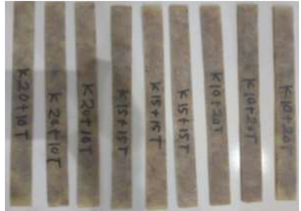
Gambar 6. Spesimen Uji Tarik ASTM D3039
