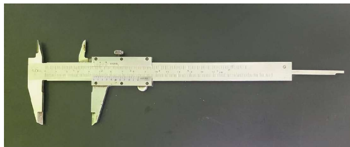
Gambar 3. 11 Jangka Sorong ketelitian 0.05mm Sumber: Dokumentasi Pribadi
