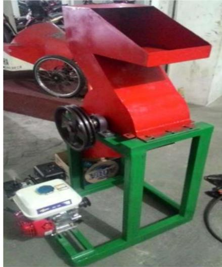
Gambar 2. 10 Mesin Pencacah Plastik
