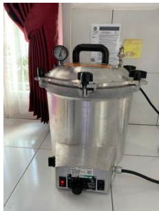
Gambar 10. Proses sterilisasi menggunakan autoklaf
