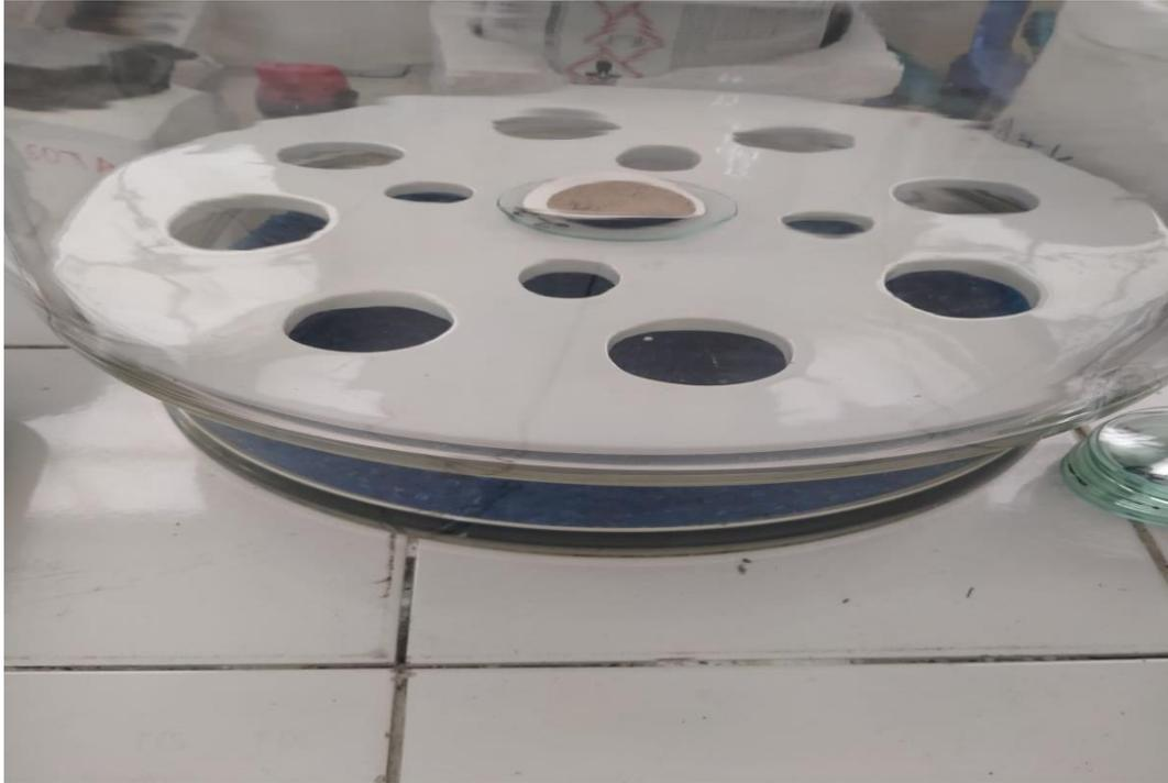
Memasukkan kertasaring yang telah dilakukan proses penyaringan ke dalam desikator selama 15 menit
