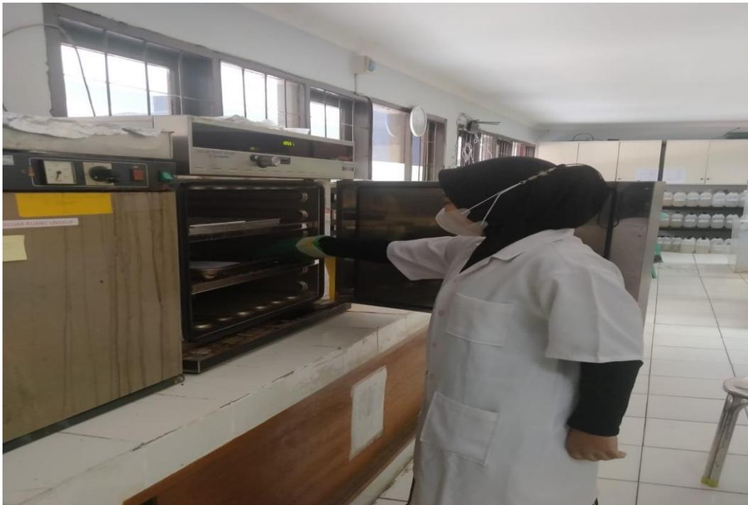
Memasukkan kerta saring yang telah dilakukan proses penyaringan ke dalam oven selama 1 jam ( $103^{\circ}\text{C}$ - $105^{\circ}\text{C}$ )
