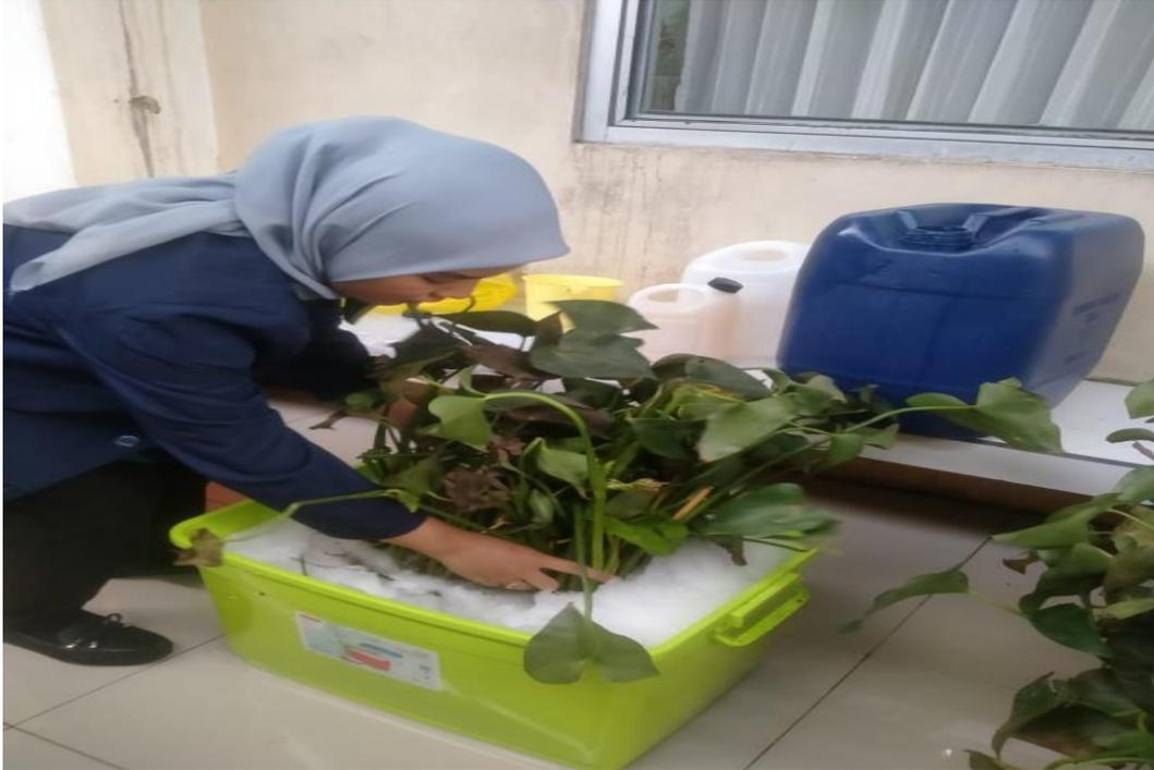
Proses peletakan tanaman eceng gondok pada reaktor A (berat 4kg)
