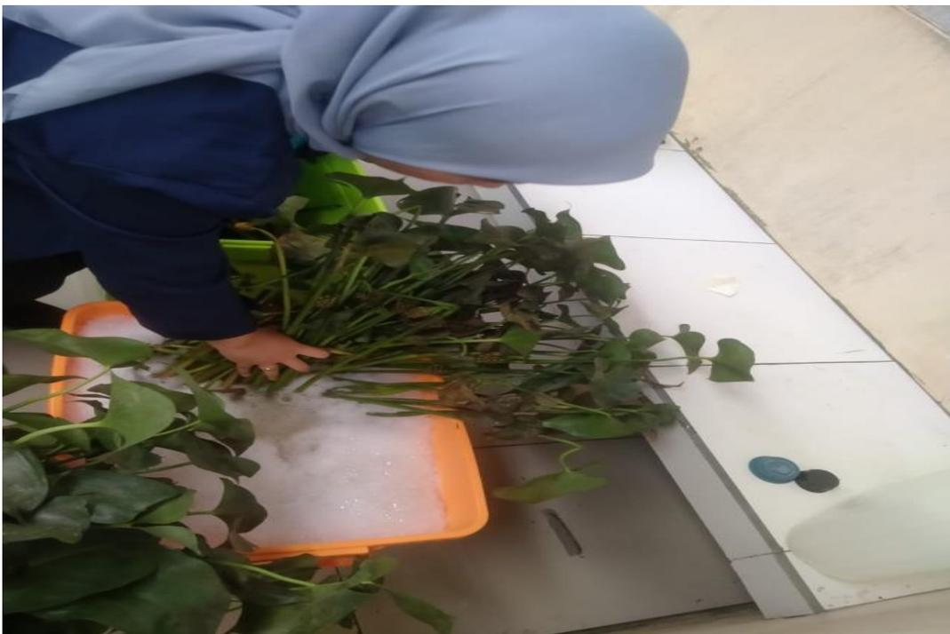
Proses peletakan tanaman eceng gondok pada reaktor B (berat 8 kg)
