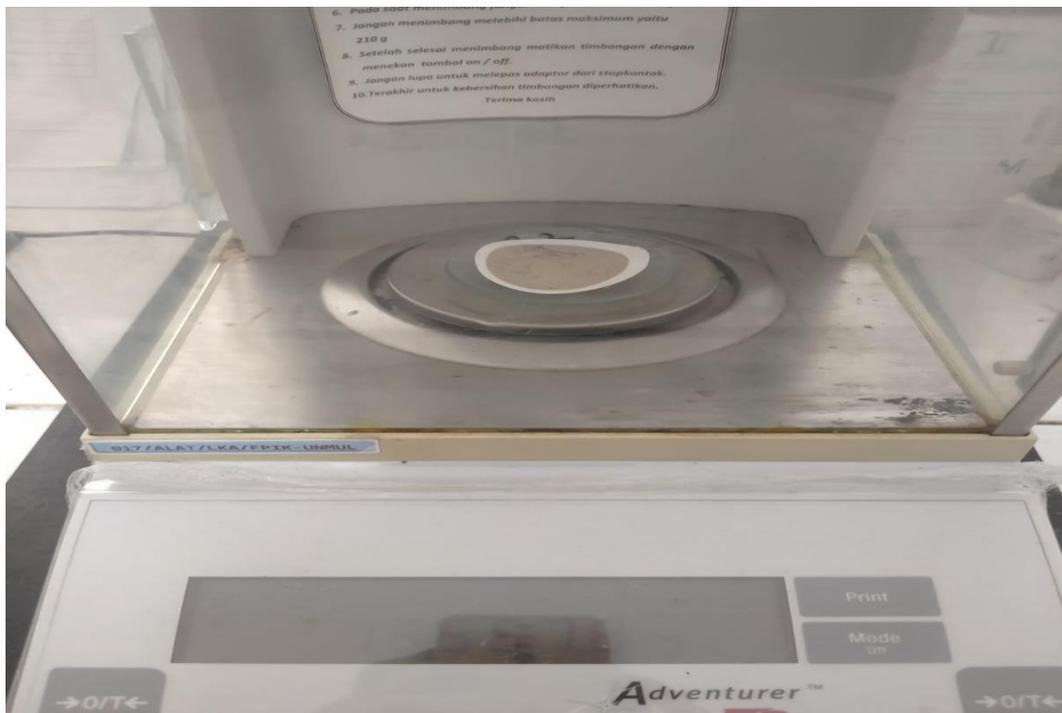
Melakukan penimbangan pada kertas saring yang telah dilakukan proses penyaringan dengan menggunakan neraca analitik
