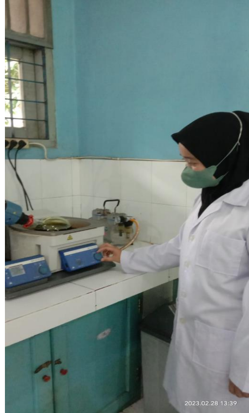
Proses mengatur putaran rotary dengan kecepatan 5-8
