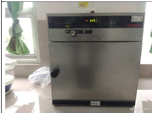
Proses pengeringan buah stroberi segar ke dalam oven dalam suhu 62,5°C selama 2x24 jam
