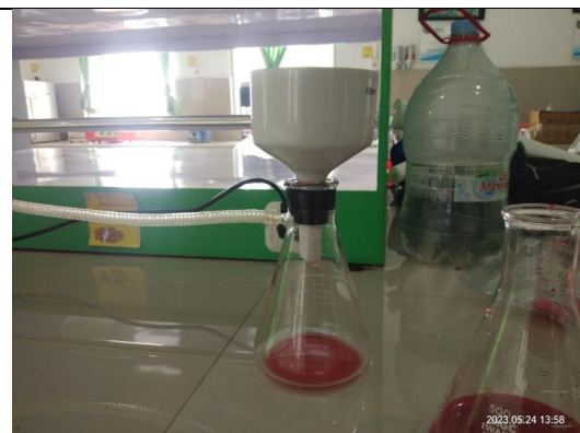
Proses penyaringan dengan alat vacum filter buah stroberi segar 100 g, 200 g dan 300 g
