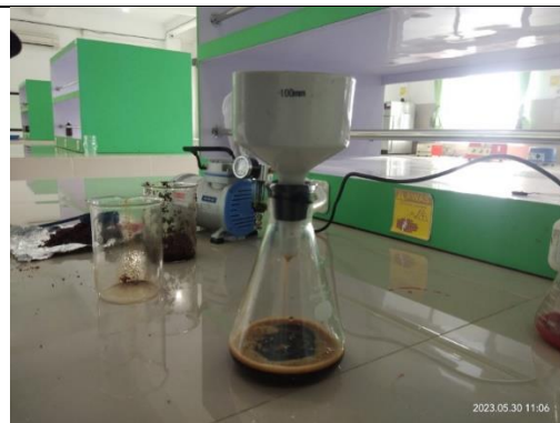
Proses penyaringan dengan vacum filtrasi
