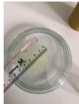
Uji Daya Sebar F3
