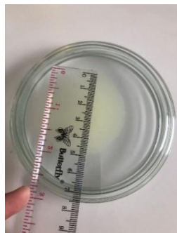
Uji Daya Sebar F2
