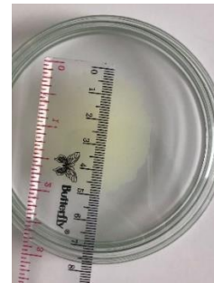
Uji Daya Sebar F1
