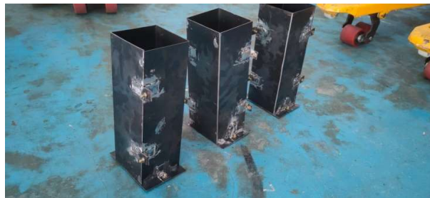
Gambar 3.2 Cetakan Benda Uji Beton Prisma
