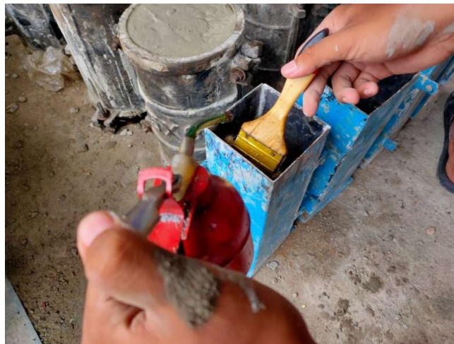
Gambar 3.8 Pelumasan Cetakan Beton Prisma
