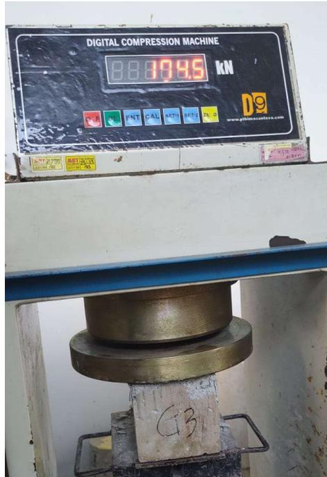
**Gambar 4.3** Pengujian Beton Kubus
