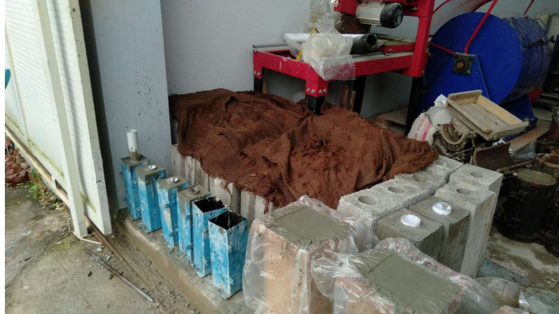
Gambar 3.9 Perawatan Beton Dengan Karung Goni
