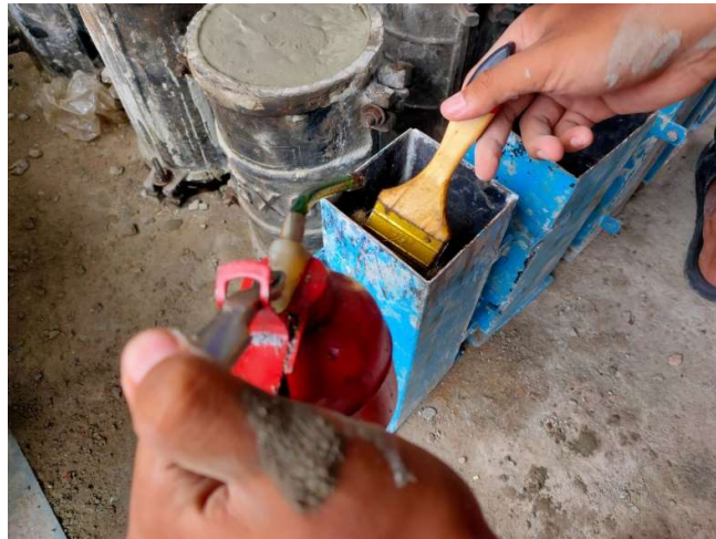
Gambar 3.8 Pelumasan Cetakan Beton Prisma
