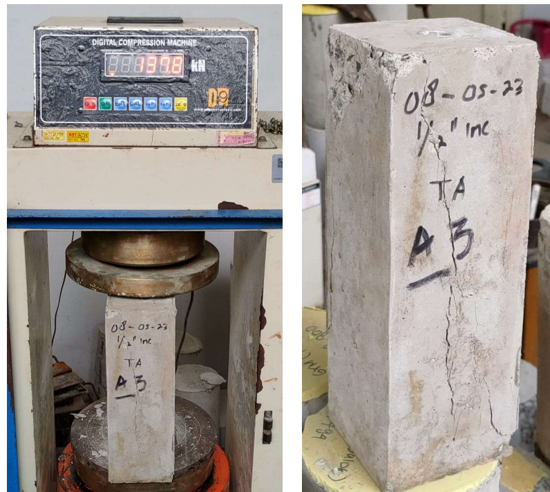
Gambar 4.5 Pengujian Gaya Tekan Beton dan Pola Retak Beton Dengan Pipa
