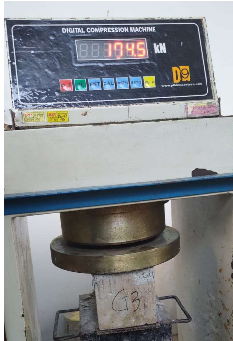
Gambar 4.3 Pengujian Beton Kubus
