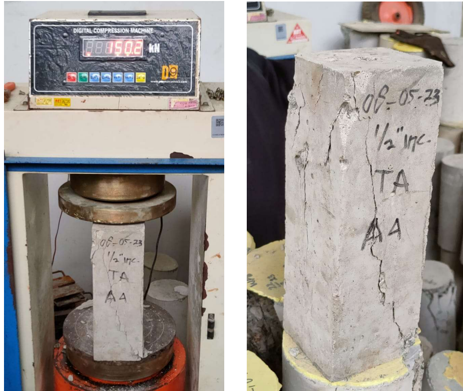
Gambar 4.7 Pengujian Gaya Tekan Beton Tanpa Pipa dan Pola Retak Beton Tanpa Pipa
