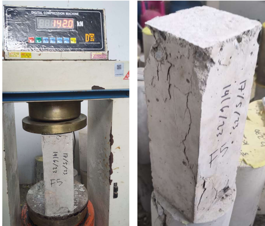
Gambar 4.2 Pengujian Beton Prisma dan Pola Retak Beton Prisma
