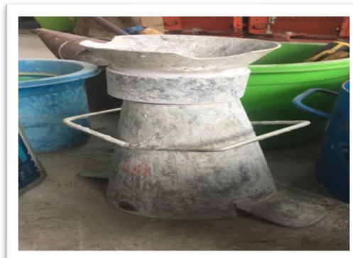
Gambar 3.9 alat slump test Sumber : penelitian (2023)
