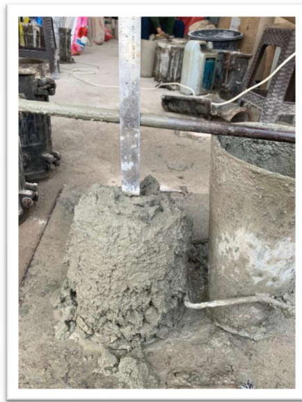
Gambar 4.15 Uji Slump Sumber : Penelitian (2023)
