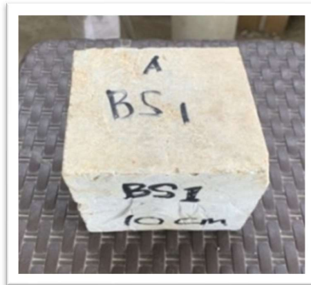
Gambar 4.10 Pegujian Kuat Tekan Batu sebelum di uji
