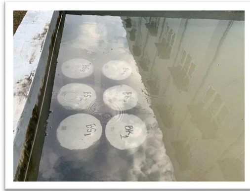
Gambar 4.16 Perawatan Perendaman Sampel Beton Sumber : Penelitian (2023)
