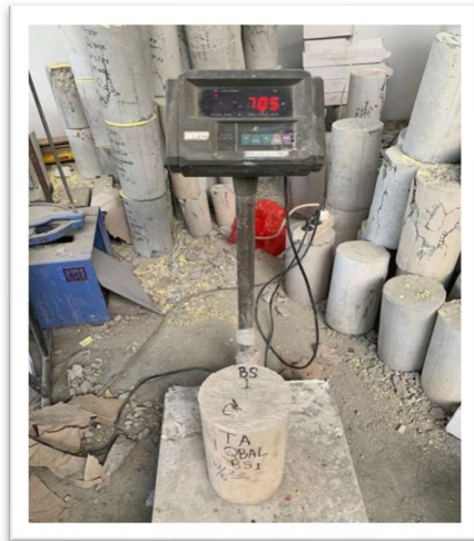
Gambar 4. 17 Penimbangan Sampel Beton Sumber : Penelitian (2023)
