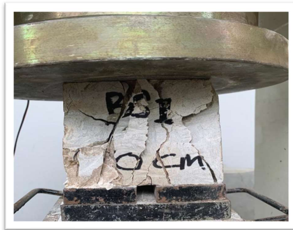
Keretakan uji kuat tekan batu 10 cm
