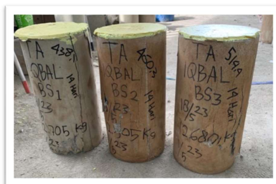
Beton setelah diuji tekan
