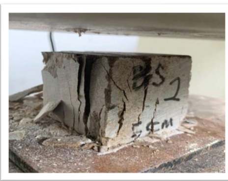
Keretakan uji kuat tekan 5 cm
