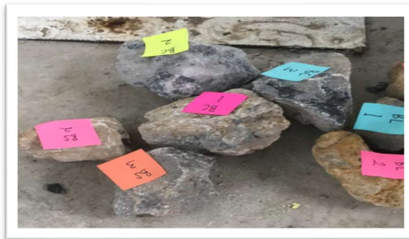
Sampel batu 5 cm sebelum dipotong
