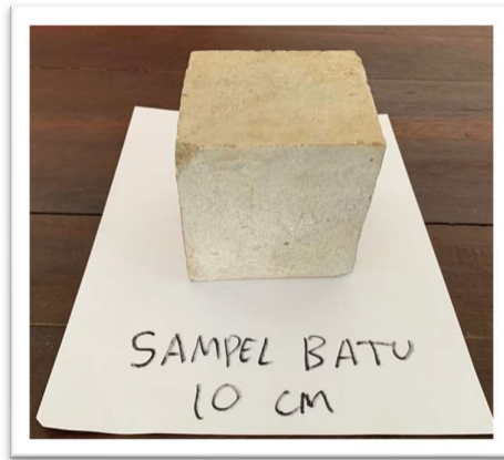
Sampel batu (BC) 1 setelah dipotong 10 cm
