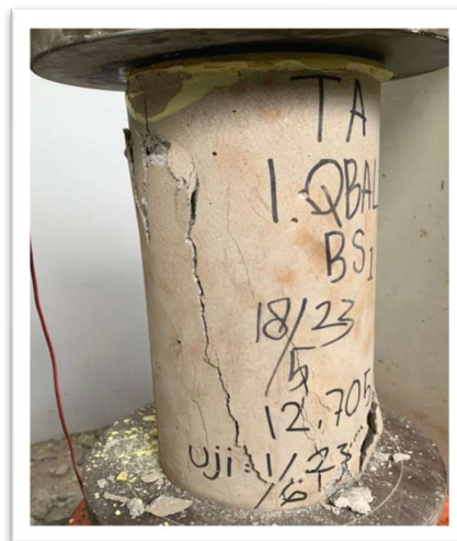
Uji kuat tekan beton
