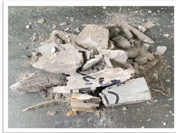
Keretakan uji kuat tekan batu 5 cm
