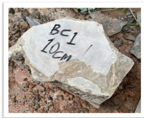
Sampel batu Cermin 10 cm sebelum dipotong kubus
