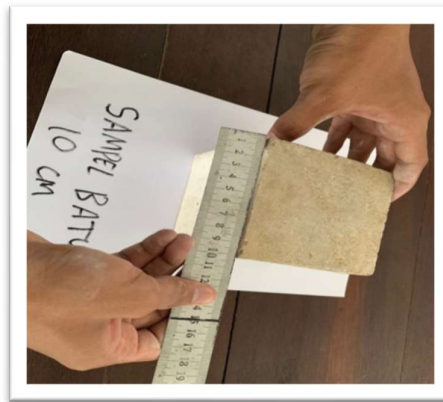
Sampel batu (BC) 1 setelah dipotong 10 cm
