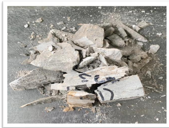
Keretakan uji kuat tekan batu 5 cm
