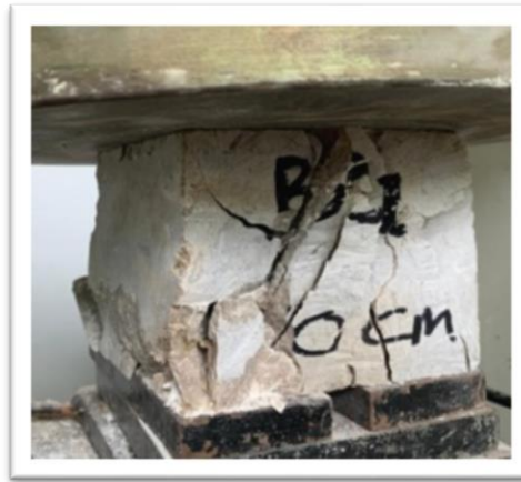
Gambar 4.11 Pengujian Kuat Tekan Batu Saat di uji Sumber Penelitian (2023)
