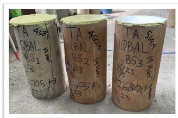
Beton setelah diuji tekan
