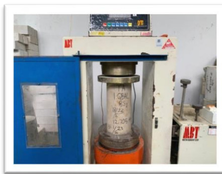
Gambar 4.18 Pengujian Kuat Tekan Beton
