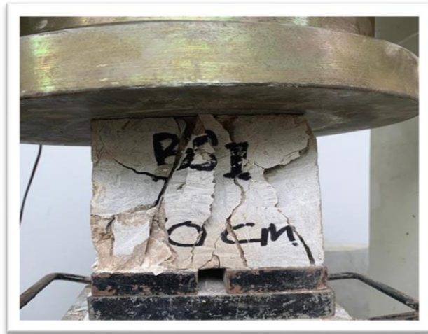
Keretakan uji kuat tekan batu 10 cm
