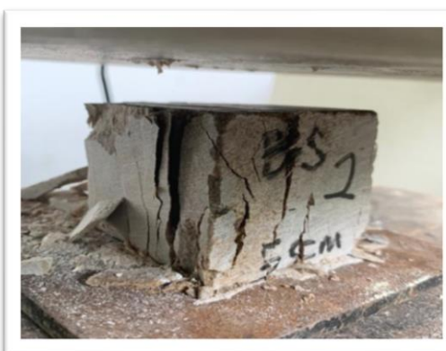
Keretakan uji kuat tekan 5 cm
