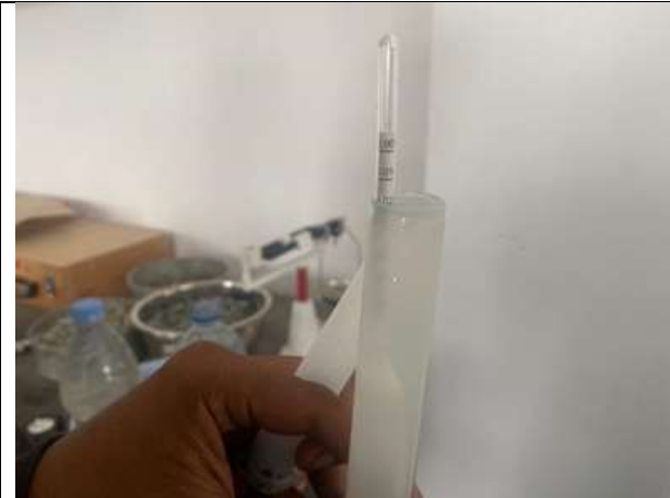
Pengujian Kadar Garam Menggunakan Hidrometer
