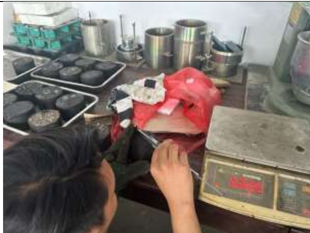
Pengukuran Benda Uji Menggunakan Jangka sorong
