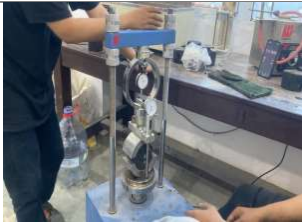
Pengujian Menggunakan Alat Marshall
