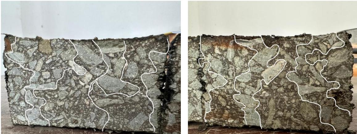
**Gambar 3. 18** Pengujian Penetrasi Air Laut (Uji Belah) Filler Fly Ash
