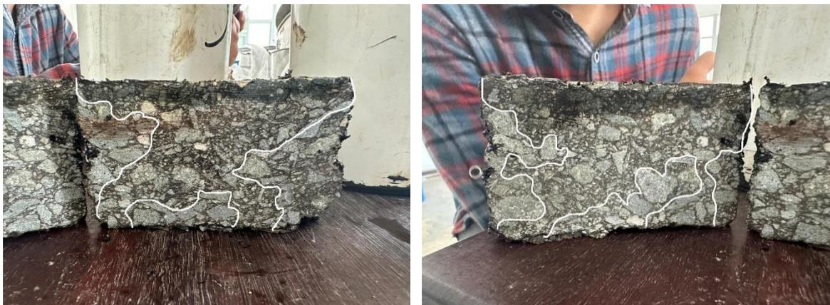
**Gambar 3. 19** Pengujian Penetrasi Air Laut (Uji Belah) Filler Normal/Abu Batu
