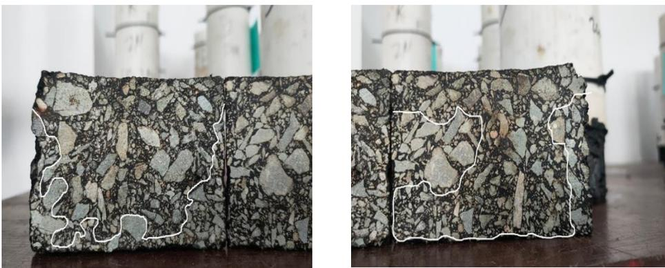
**Gambar 3. 21** Grafik Pengujian Penetrasi Air Laut (Uji belah) *Filler Fly Ash*
