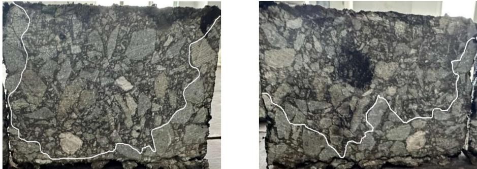
**Gambar 3.22** Grafik Pengujian Penetrasi Air Laut (Uji belah) *Filler* normal
