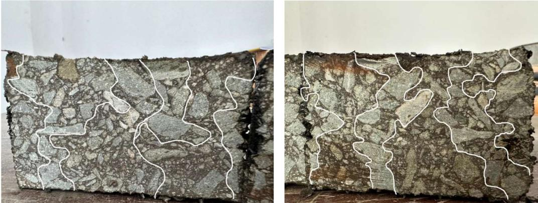
**Gambar 3. 18** Pengujian Penetrasi Air Laut (Uji Belah) Filler Fly Ash
