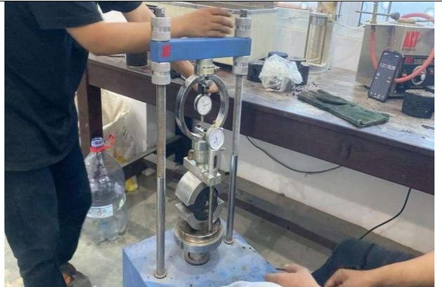
Proses Pengujian Uji Belah Pada Sampel
