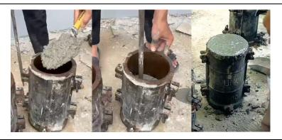
Benda uji beton yang telah kering 24 jam
