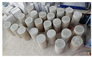
Proses perendaman benda uji beton di dalam bak perendaman
