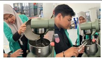
Proses pencampuran bahan pengujian konsistensi normal semen
