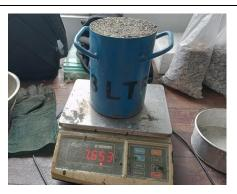
Proses penimbangan pada pengujian kadar air agregat halus
