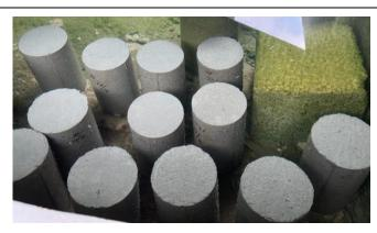
Proses penimbangan benda uji beton sebelum pengujian kuat tekan
