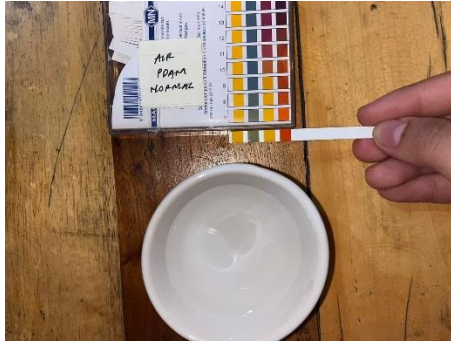
Gambar 2. Pengujian air pH 7,0
