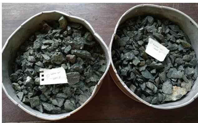
Pengujian kadar air
