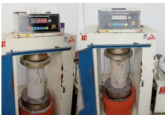
Proses pengujian kuat tekan beton pH 7,0 dan pH 9,5 menggunakan alat *Compression Testing Machine*
