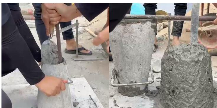
Proses pengujian *slump*
