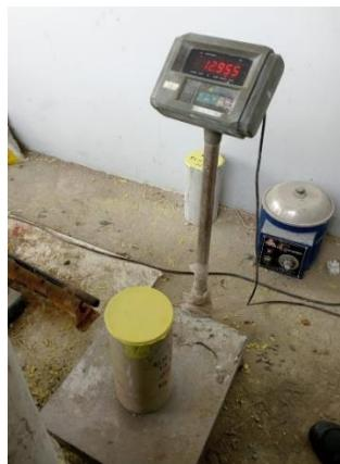
Proses penimbangan benda uji beton sebelum pengujian kuat tekan
