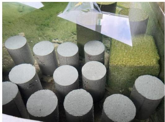
Proses perendaman benda uji beton di dalam bak perendaman
