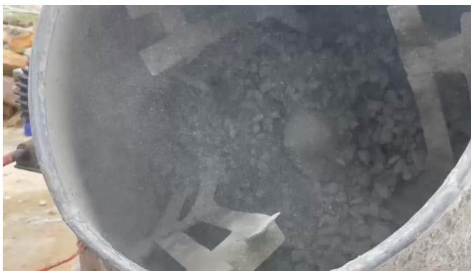
Pengecekan material untuk memastikan bahan telah tercampur dan mengecek konsistensinya
