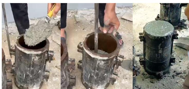
Proses pencetakan dan penuangan benda uji beton kedalam silinder 15 x 30 cm dengan cara dirojok, kemudian meratakan permukaan atas beton
