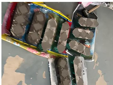
Proses pencetakan benda uji matrix
