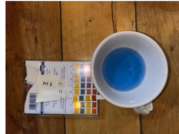
Gambar 4 Pengujian Air Alkali pH 8,0
