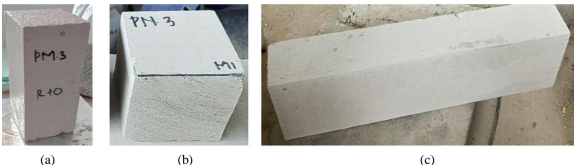
Gambar 2. Benda Uji Sifat Mekanik (a) Prisma Balok, (b) Kubus, (c) Bata Utuh
