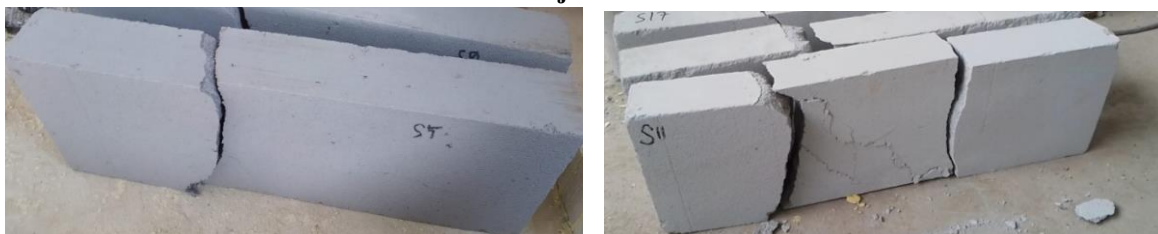
Gambar 3. 10 Pola Keretakan Benda Uji Bata Utuh
