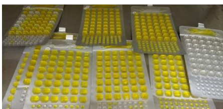
Gambar 1.7 Hasil uji air baku parameter mikrobiologi mata air dan sumur bor
