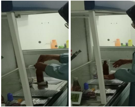
Gambar 1.4 Pengujian sampel air memasukan colilert-18 ke dalam sampel air
