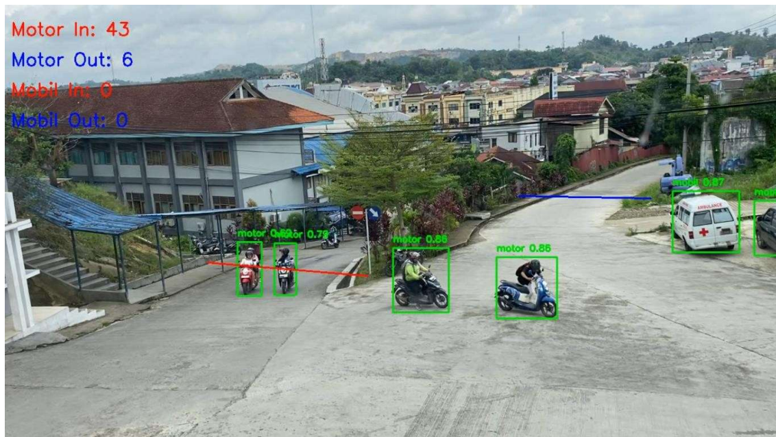
Gambar 3.11 Hasil Deteksi & Perhitungan Kendaraan Keluar Masuk
