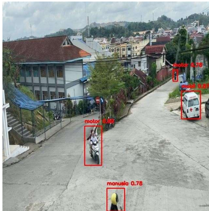
Gambar 3.10 Tahap Akhir Hasil Deteksi Algoritma YOLOv8
