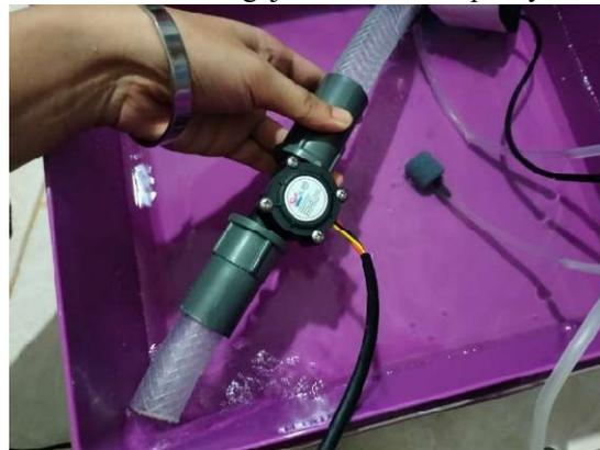
dapat dilihat pada gambar 3.2 dan gambar 3.3 diatas menunjukkan kondisi dimana ketika terdapat aliran air yang melewati sensor maka aerator akan mati dan ketika tidak terdapat aliran air yang mengalir melewati sensor maka aerator akan menyala. Hal tersebut dapat disimpulkan bahwa sensor *waterflow* yang telah di rakit dapat bekerja dengan baik.
