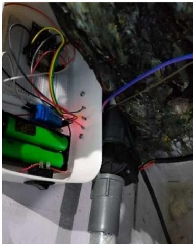
**Gambar 3. 9** Pemasangan Sensor
