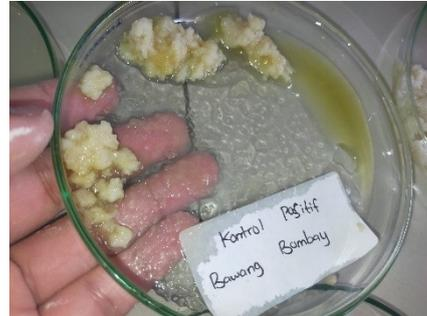
Gambar 2. Uji Kontrol positif boraks menggunakan ekstrak bawang bombay
