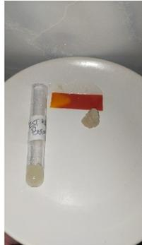
Gambar 1. Uji kontrol positif boraks menggunakan test kit
