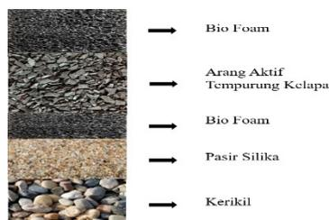
**Gambar 3. 3 Susunan Media Filter Pada Alat Penelitian**
