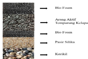
Gambar 3. 3 Susunan Media Filter Pada Alat Penelitian
