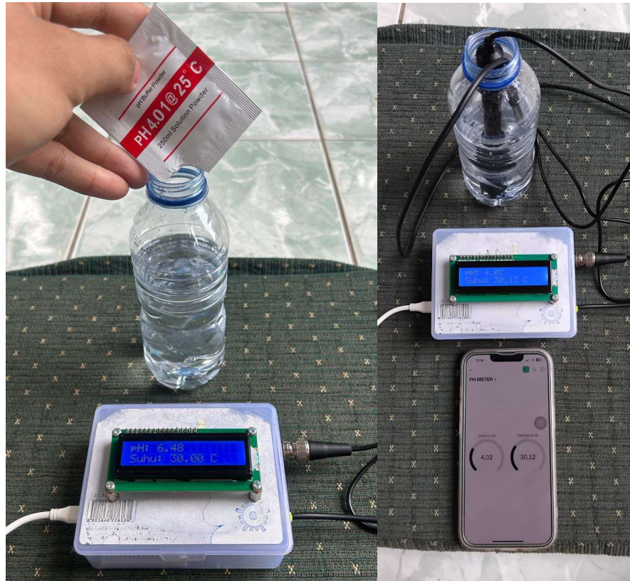
Gambar 3. 5 Hasil Kalibrasi dengan bubuk pH Meter Dengan Kadar pH 4.00
