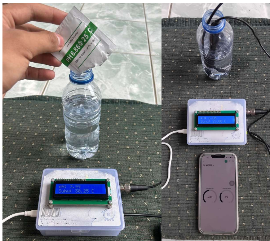
Gambar 3. 6 Hasil Kalibrasi dengan bubuk pH Meter Dengan Kadar pH 6.86
