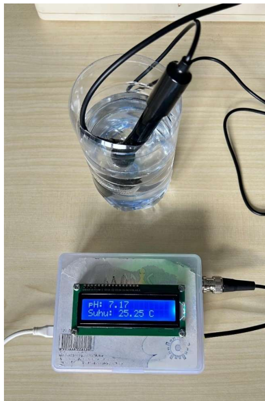
Gambar 3. 8 Sensor Mulai Mendeteksi pH dan Suhu Air
