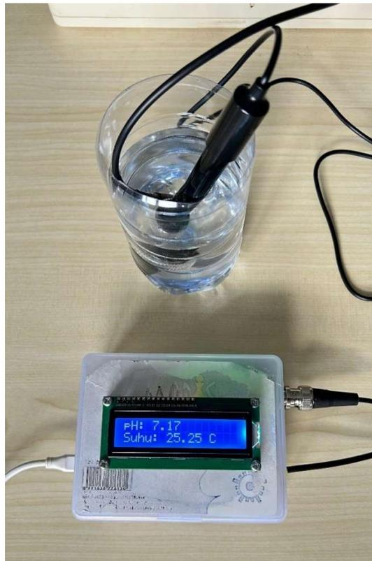
*Gambar 3. 8 Sensor Mulai Mendeteksi pH dan Suhu Air*
