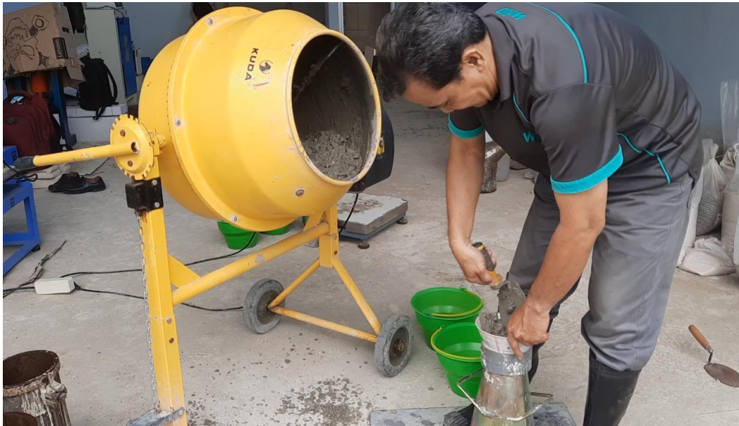
Gambar 8. Lokasi Laboratorium Teknik Sipil UMKT Uji Slump
