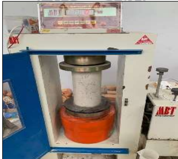
Gambar 2. 5 Pengujian Kuat Tekan Beton
