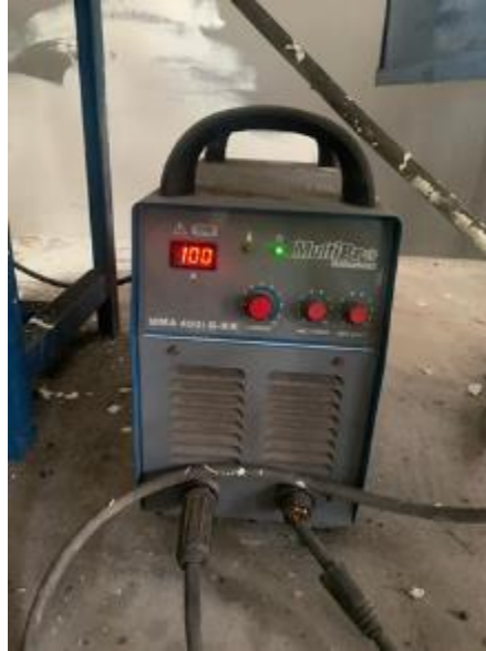
Gambar 3. 5 Mesin las SMAW Multi Pro
