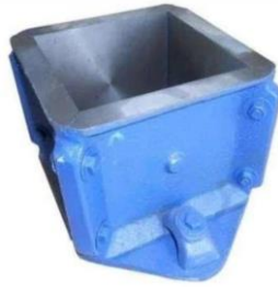
Gambar 3. 2 Cetakan Benda Uji Kubus
